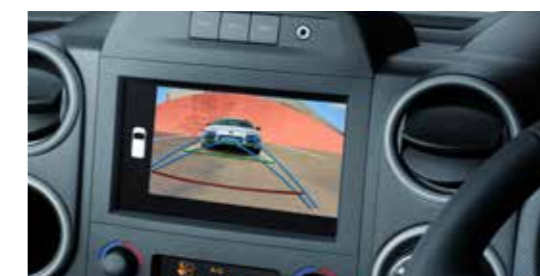
Cámara de retroceso
